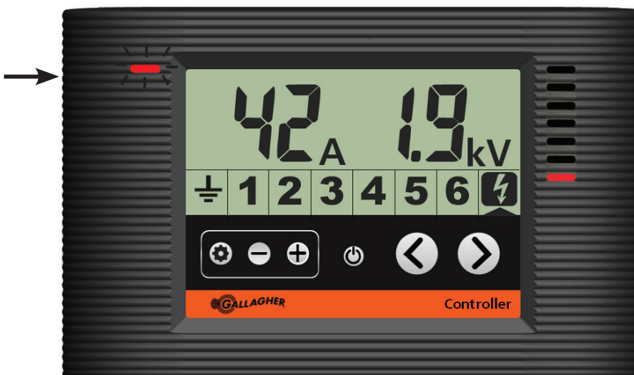
Kontrolleren viser, at spændingsgiveren har udløst en udgangsalarm
