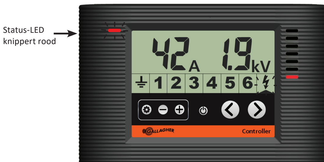
Bedieningspaneel toont het schrikdraadapparaat in stroomsterktealarm
