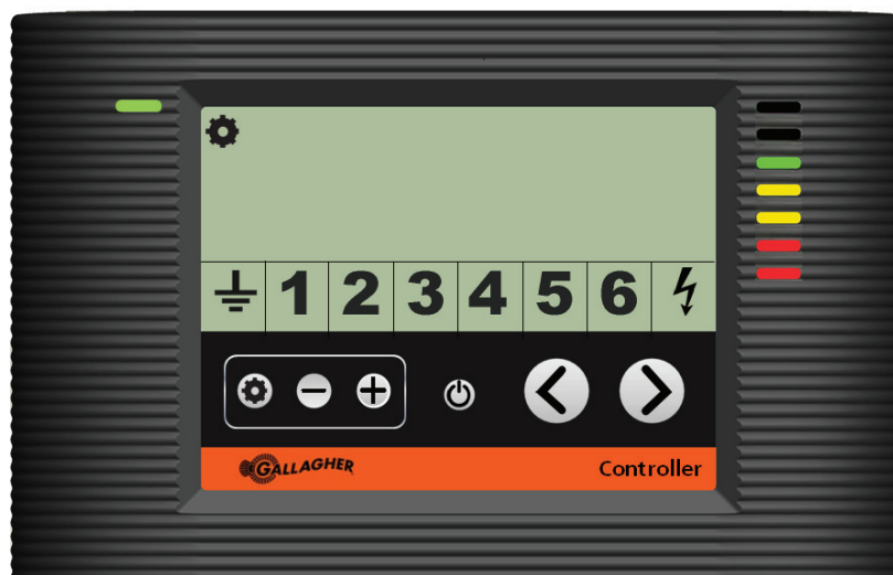
Kontrolleren viser udgangsspænding, der bliver justeret.
