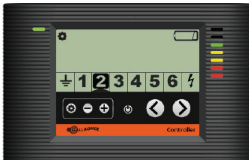
Kontroll visar zon 2 med en låg batterinivå
