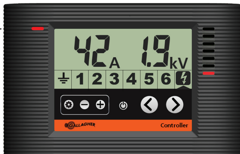
Contrôleur montrant l'électrificateur en état d'alarme
